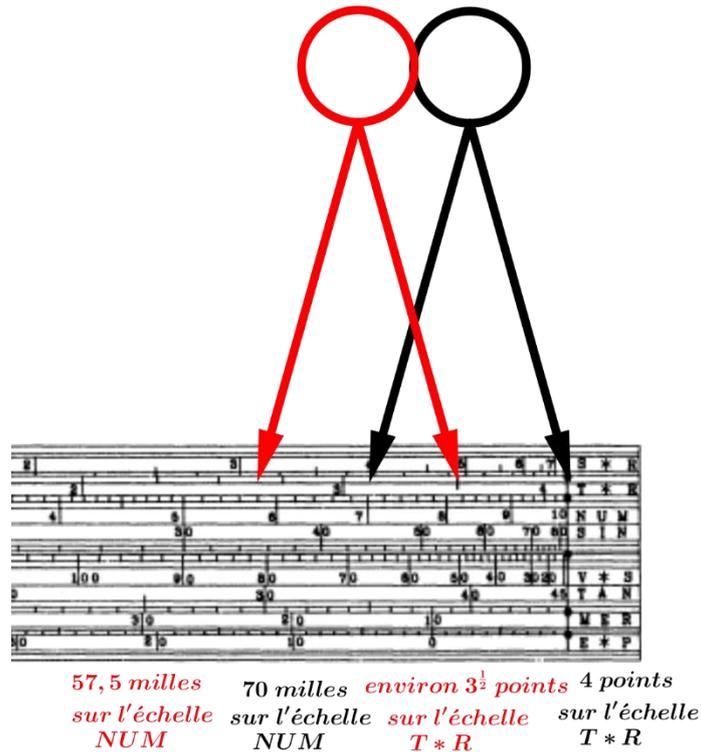
On lit sur l'échelle un cap de 3 rums 1/2 dans le SE, qui donnent en degrés, 39° 22,5' proche des 39° 20' indiqués dans le texte.
