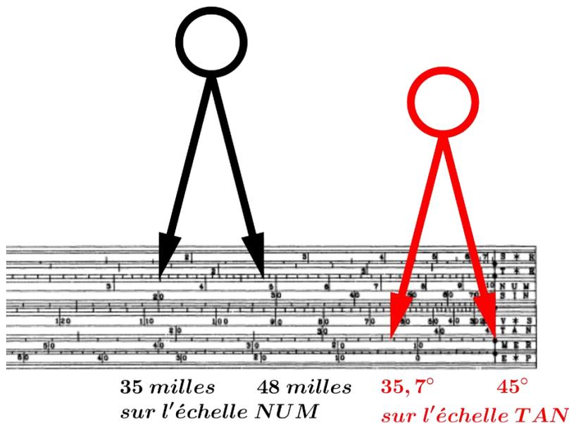
**UTILISATION V** Étant donné l'hypoténuse d'un triangle sphérique rectangle de 60 degrés, par exemple, et un des côtés de 20 degrés, trouver l'angle opposé à ce côté.
