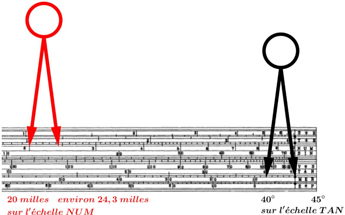
**UTILISATION IV** Étant donné la base d'un triangle rectangle de 35 milles, par exemple, et la perpendiculaire de 48 milles, trouver l'angle opposée à cette perpendiculaire.
