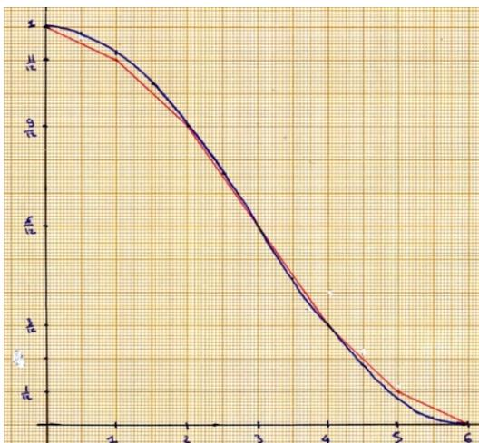
La figure ci-dessus met en évidence le fait que cette règle est une approximation linéaire par morceaux (en rouge) d'une fonction cosinus (en bleu). Avant l'invention des calculatrices, c'était un outil remarquable pour résoudre simplement ce type de problème. Désormais si on souhaite un calcul assez précis, il peut être plus simple de programmer la fonction.
